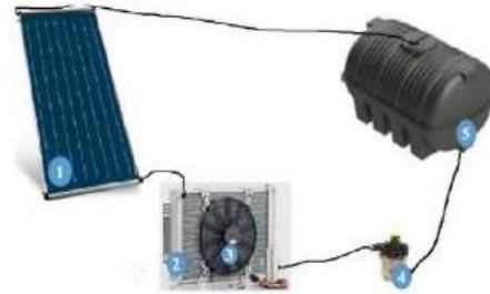
2-rasm. Yangi tipdagi FIQ ning yangi tipdagi sovitish sistemasining sxemasi.
