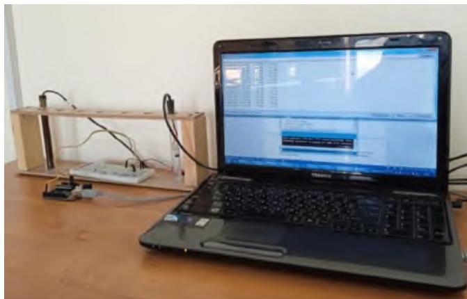
7-rasm. Fazaviy o'tish vaqtida haroratlarni o'lchash jarayoni.
