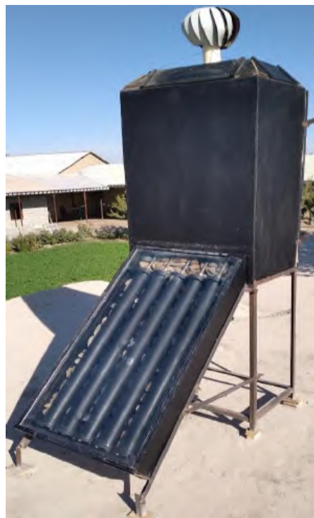
Рис. 1. Солнечная сушильная установка непрямого действия:
