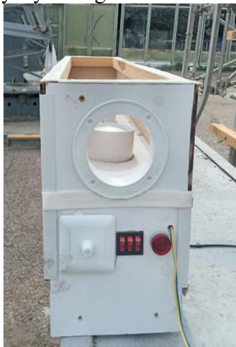
1-rasm. Fotoelektrik modullar bilan integratsiyalangan tromb devori tizimining tashqi ko‘rinishi uning asosiy konstruktiv elementlari va umumiy tuzilishi keltrilgan.
