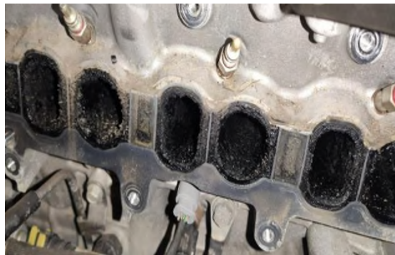
4-rasm. Ichki yonuv dvigatelidagi so'rish tizimining ifloslanishi.
