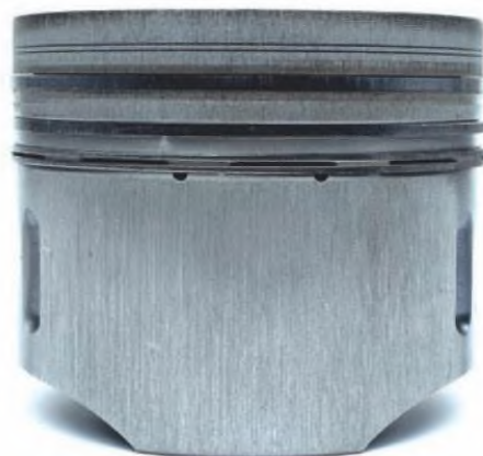
3-rasm. Silindr – porshen guruhining abraziv yedirilishi.
