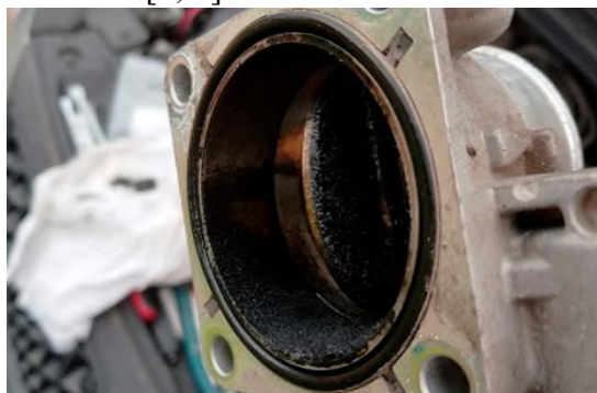
4-rasm. Ichki yonuv dvigatelidagi so'rish tizimining ifloslanishi.
