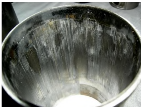
3-rasm. Silindr – porshen guruhining abraziv yedirilishi.
