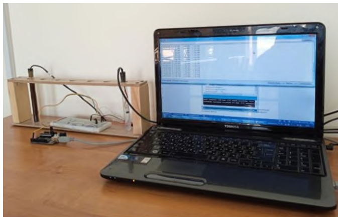
7-rasm. Fazaviy o‘tish vaqtida haroratlarni o‘lchash jarayoni.
